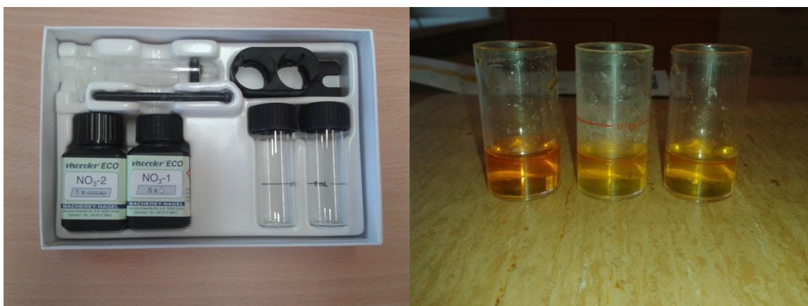
3 pav. Vandens mėginių tyrimas „Visocolor ECO“ firmos reagentais
